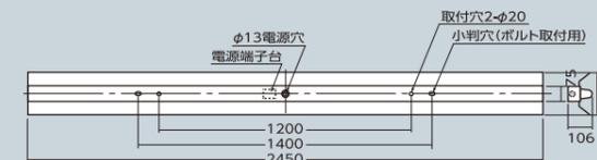
**反射笠(笠付)型 110形1灯用 [専用支持金具付]**
