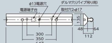
**反射笠(笠付)型 110形2灯用 [専用支持金具付]**
